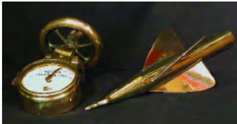
245. Loch à hélice en trois éléments. Compteur en bronze divisé par miles et centaines de miles signé C. PLATH à Hambourg. Allemagne, vers 1900. Photo ci-dessous
