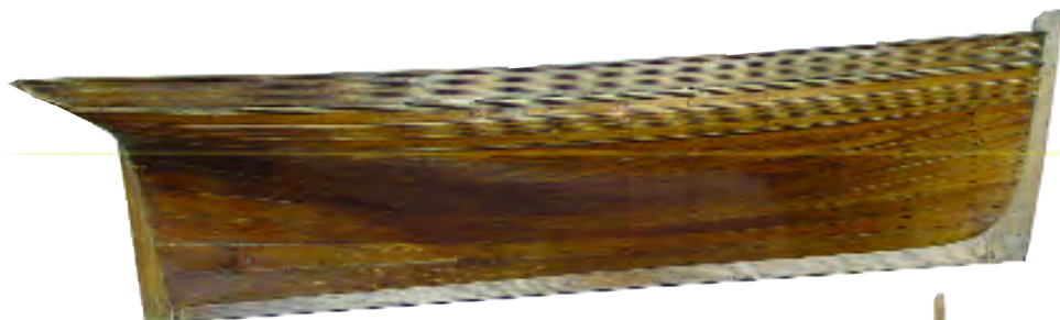
257. Maquette de chantier de ketch harenguier. Coque bordée sur menbures. Chêne verni. C. 1900. Long. 1,14 m.
