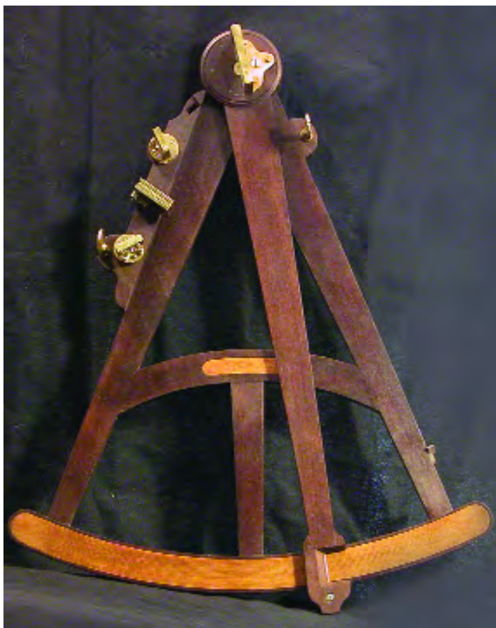
104. Grand octant en acajou et laiton. Lecture sur limbe en bois fruitier divisé transversalement. Visée par double jeu de pinules, jeu de filtres déplaçable. Rayon utile : 45 cm (1,5 pied anglais). Angleterre, 18ème siècle. Photo ci-dessus
