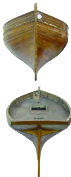
257. Maquette de chantier de ketch harenguier. Coque bordée sur menbures. Chêne verni. C. 1900. Long. 1,14 m.
