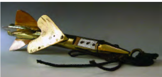
244. Loch à hélice en deux éléments. Compteur en bronze à volant d'inertie intégré. Marqué "Negus taf-trail log". Poisson en laiton. Angleterre, fin 19ème siècle. Photo ci-contre
