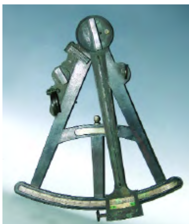
105. Octant en ébène, ivoire et laiton. Visée par pinule, lecture par vernier. Plaque en os et portemine. Fin 18ème s. Rayon : 33 cm. Photo ci-contre
