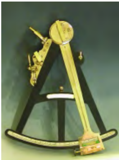
112. Octant en ébène, ivoire et laiton. Visée par pinnule, lecture par vernier. Plaque en os et portemine. Fin 18ème s. Rayon : 33 cm.
