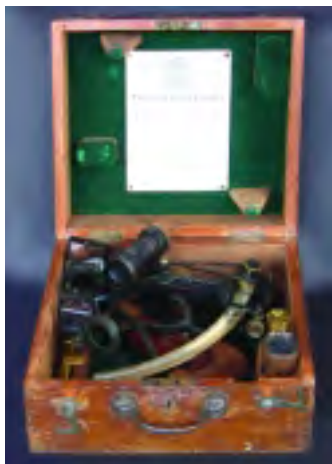
117. Sextant en bronze et laiton. Vernier et limbe divisés sur argent. Signé Hughes & Son à Londres. Coffret avec ses accessoires. Fin 19ème.
